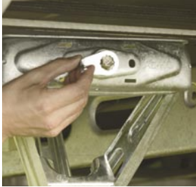
Wcisnąć zabezpieczenie blokujące obrót wrzeciona
